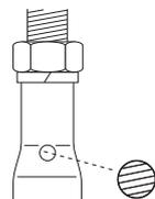
⑧ 「ターンバックル」を固定しながら上下の「ロックナット」を締め付けて完了です。
