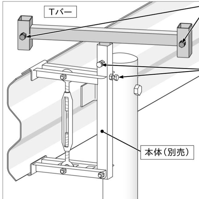
2. 重ねた看板の脚を差し込み、六角ボルトで固定します。
