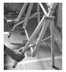
② 開き止めが水平になるまで脚を開き 再びネジを締め付けます。
