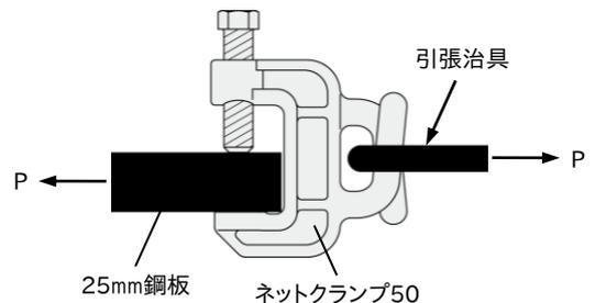
H鋼のフランジに見立てた厚さ25mmの鋼板を試験機に固定し、これに
