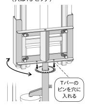
6. 本体の六角ボルトで固定して取付完了。(注. Tバーの高さは調整できません。)
