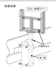
1. ブロー枠用Tバー(以降Tバー) を本体に差し込み、本体の六角 ボルトで仮締めします。
