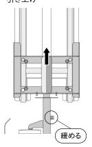
5. 向きを合わせたらピンが2本と も穴に入るように下ろします。 (穴は15°ピッチ)
