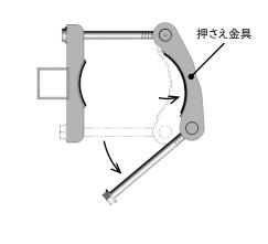
2. ガードレール支柱の頭にストッパーを載せ支柱側面 にブラケットを密着させてください。
