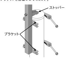
3. 押さえ金具を閉じ、上下の六角長ボルトを均等にしっかりと締め付けます。 (注. 丸ボルトは回さない。)
