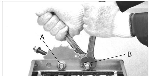
④ 取付金具との噛み合わせに注意しながらロックプレートを押し込み、B、Aの順にナットをしっかりと締め付けてください。
