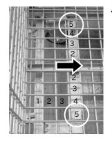
1 パレット底面の端から4つ目、中心からそれぞれ5つ目の網目にハンガー部を下側から通し、パレットの中央方向へ押しながら線材に引っ掛けてください。
