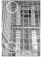
**2** フックボルトを引き上げ、パレットの外側の線 材に引っ掛けてください。
