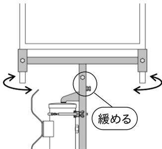
4. 本体の六角ボルトで固定して取付完了。
