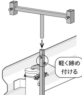
2. 畳んだ看板の脚を差し込み、Tバーの六角ボルトで固定します。
