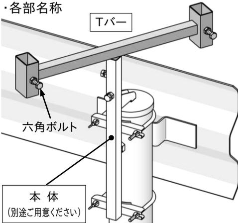
1. Tバーを本体に差し込み、本体の六角ボルトで仮締めします。
