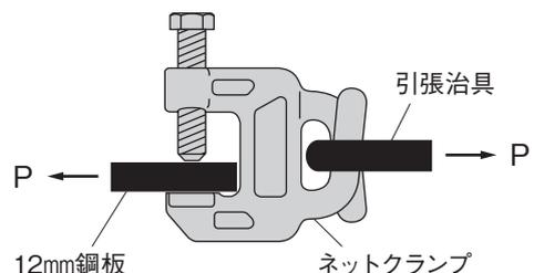
H鋼のフランジに見立てた厚さ12mmの鉄板を試験機に
